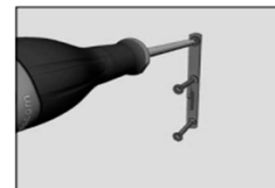
4- Fijar el gancho en la pared.
