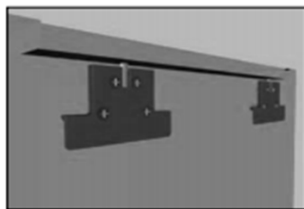
2- Fijar las piezas en la trasera del módulo.
