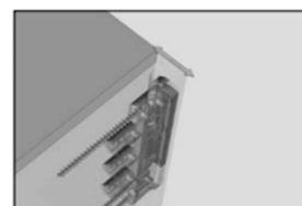
7- Regular horizontalmente si es necesario.
