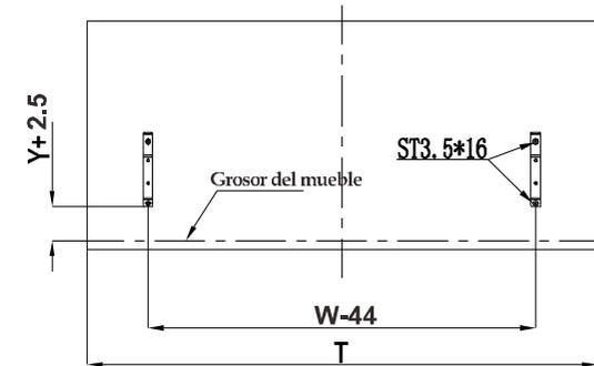
**Paso 1:** Instalar las guías en el interior del módulo de forma simétrica.
