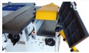
● Función regreuso levantando mesas de cepillar
