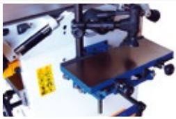
● Pie de taladrar con regulación X Y Z
