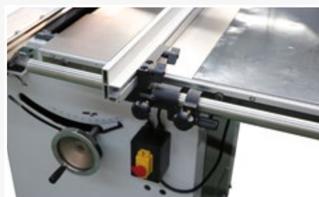
● Regulación micrométrica guía lateral
