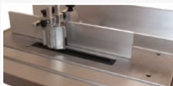
● Tupi fresador con guía de protección
