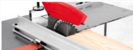
• Protector de la mesa. En función sierra circular permite el escuadrado de tableros de 1200 x 600 mm
