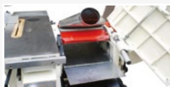
• Función regruesadora levantando mesas de cepillar, bloqueo de seguridad
