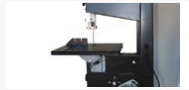
● Guía cinta superior a rodamientos
