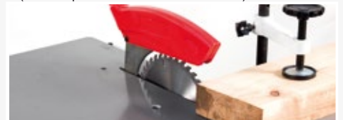
• Permite el corte por testa
