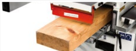
• Regruesadora con capacidad hasta 90 mm (altura)
