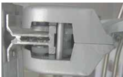
Detalle de la sección del rail guía y la pieza móvil en posición
