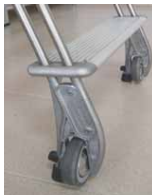
La escalera en posición vertical apoya sobre las ruedas. En posición inclinada apoya sobre lostacos plásticos
