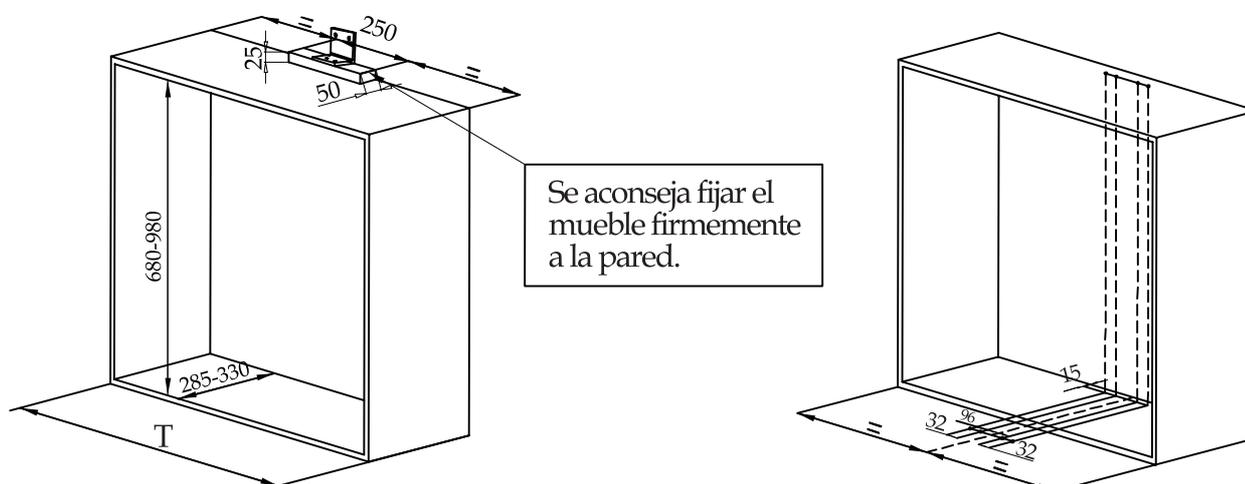
**Paso 3:** Instalar el producto con 8 tornillos de 3.5 x 16mm.
