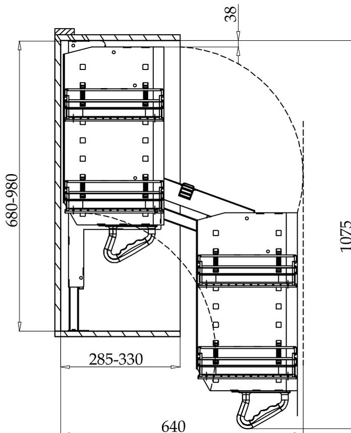
**Paso 2:** Realizar 8 perforaciones de  $\varnothing$  2,5mm respectivamente en el panel del mueble que se indica.
