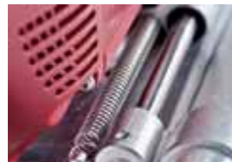
La placa base cubre en todo momento el disco de corte gracias a la presión de un potente muelle
