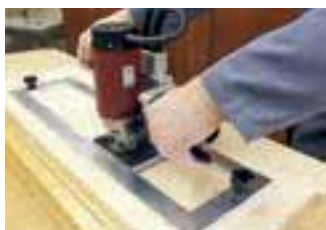
Plantilla de fresado para listones de parcheo
