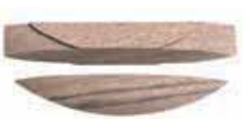
Paso 4: Cortar el parche de madera
