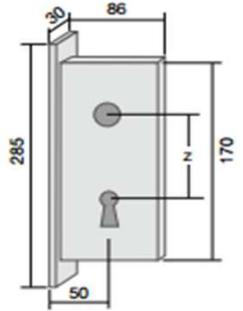
En Z se indican 2 medidas, la primera es la que va en la parte interior, y la segunda la que va al exterior. Si la puerta abre al revés, las medidas serán a la inversa. Esta cerradura es un modelo muy indicado para porterías, porque al tener un pivote cerradero menos permite acoplarse al cierre eléctrico.
