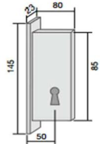
Para instalación en puertas con apertura hacia el exterior.
