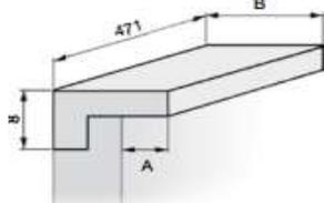
Si la medida del interior no se adaptara a ninguna de estas regletas, éstas pueden cortarse con facilidad para ajustarse. La colocación de estas regletas es necesaria, ajustándose al ancho según el tipo de cajón. No tienen mano, **debiendo pedirse dos por cajón**. Se coloca a presión, sin necesidad de ninguna mecanización, permitiendo desmontarse.
