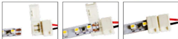
Ejemplo de unión conector rápido (sin soldadura) + tira LED
