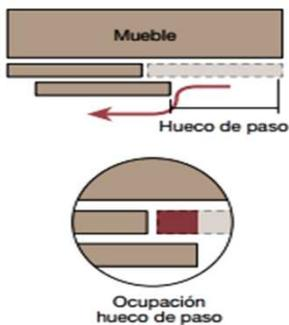
El modelo L se fabrica con una guía inferior ajustable, y una guía superior no ajustable. De esta forma, la mitad del ajuste nos ocupará el hueco de paso, con la posible obstaculización de cajones en el interior del armario.
