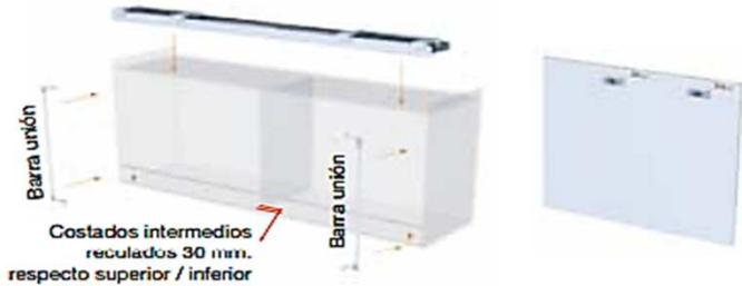
Barra unión = HI (altura interior mueble) + SPC (espesor tablero) - 94,5
