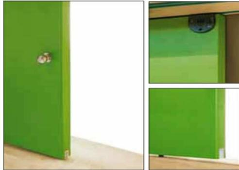
El sistema de hojas correderas "System 0350/15" permite deslizar una hoja de mueble de 15 kg. Deslizamiento por la parte superior, dejando el suelo libre. Guía de dimensiones reducidas, por lo que puede ocultarse en la parte superior con solo 25 mm. de espesor. El deslizamiento a ras de mueble hace innecesario tapar el sistema. Carros regulables en altura de 3 mm. y desmontables en dos partes acopladas a presión.
